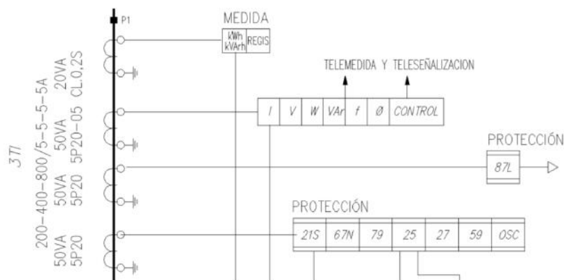
Figura 87: Ejemplo de conexión de un TI con cuatro devanados
