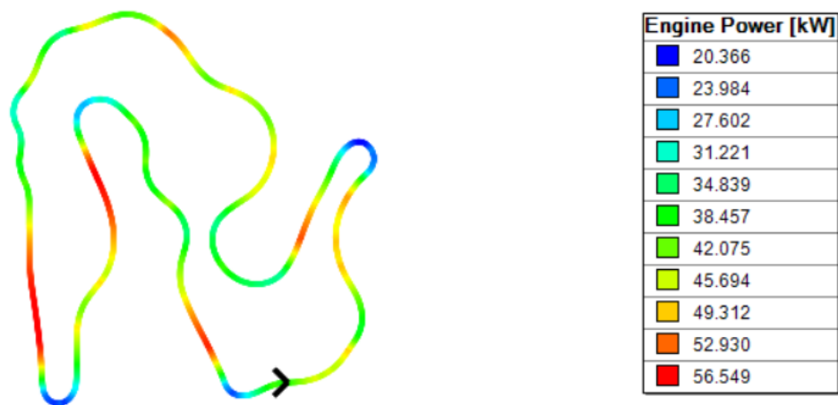
Figura 4.4: Potencia instantánea entregada por el motor del ISF-05 en el circuito de Endurance de Austria 2012 (963.81m), salida del OptimumLap .
