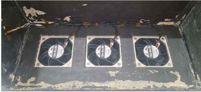
(a) Montaje empotrado de los tres ventiladores empleados, visto desde el interior del acumulador.
