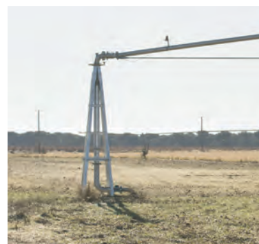
Conjunto Pivote Central. Incluye sistema cierre cañón.
