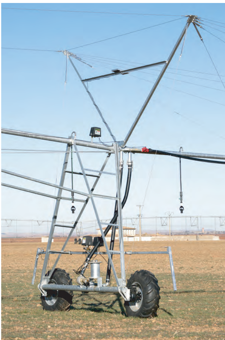
Detalle de Unidad Motriz con Sistema de Conversión de Potencia Hidráulica y Sistema Sectorial.
