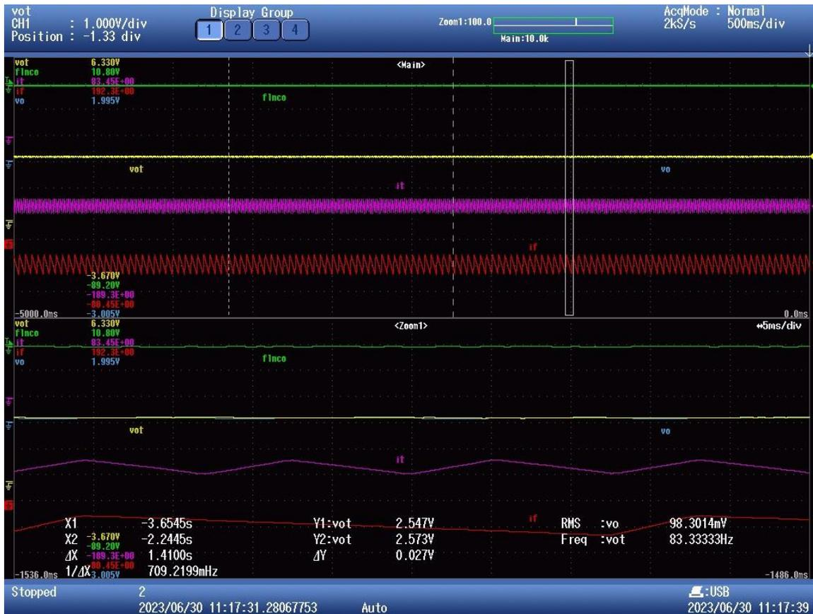
Figura 7-2 Ensayo de lazo abierto en régimen permanente de 3.3V. Amarillo- Vout. Rojo- Corriente de una de las fases. Morado- Corriente de todas las fases
