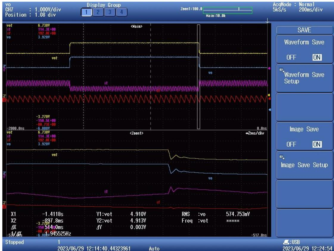
Figura 7-5 Transitorio cambio de referencia entre 4 y 5V (zoom en la caída de voltaje). Amarillo- Vout. Azul-Vout menos 4V. Rojo- Corriente de una de las fases. Morado- Corriente de todas las fases
