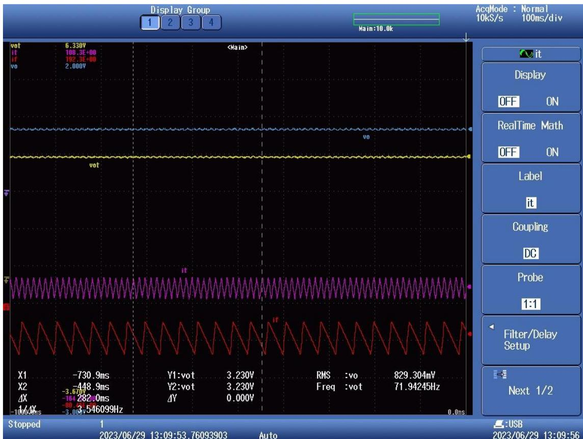
Figura 7-4 Lazo cerrado en régimen permanente para 3.3V. Amarillo- Vout. Azul-Vout menos 2.5V. Rojo- Corriente de una de las fases. Morado- Corriente de todas las fases
