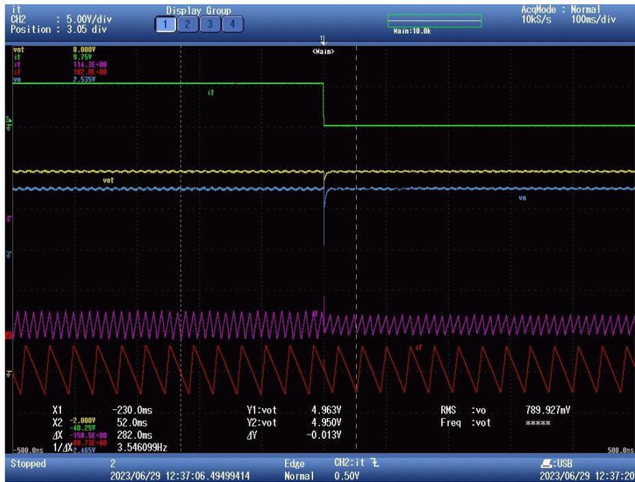
Figura 7-15 Transitorio de bajada de la tensión de entrada de 5V. Amarillo- Vout. Azul-Vout menos 4V. Rojo- Corriente de una de las fases. Morado- Corriente de todas las fases. Verde- Señal de flanco
