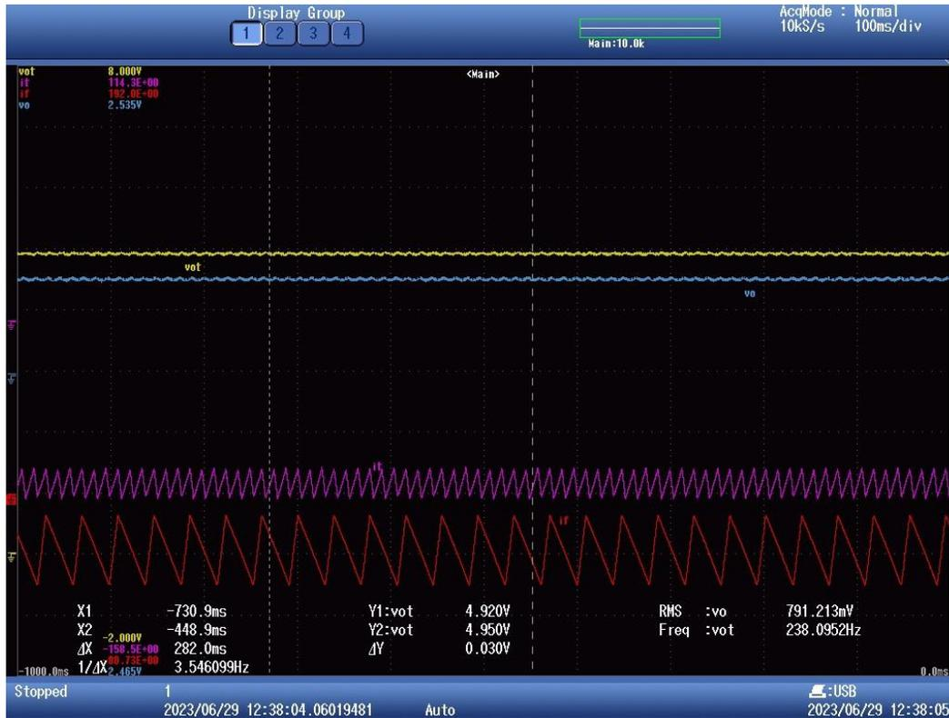
Figura 7-3 Lazo cerrado en régimen permanente de 5V. Amarillo- Vout. Azul-Vout menos 4V. Rojo- Corriente de una de las fases. Morado- Corriente de todas las fases
