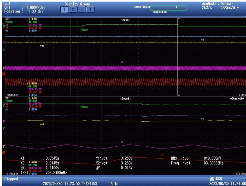
Figura 7-16 Transitorio de bajada de la tensión de entrada de 3.3V. Amarillo- Vout. Azul-Vout menos 2.5V. Rojo- Corriente de una de las fases. Morado- Corriente de todas las fases. Verde- Señal de flanco
