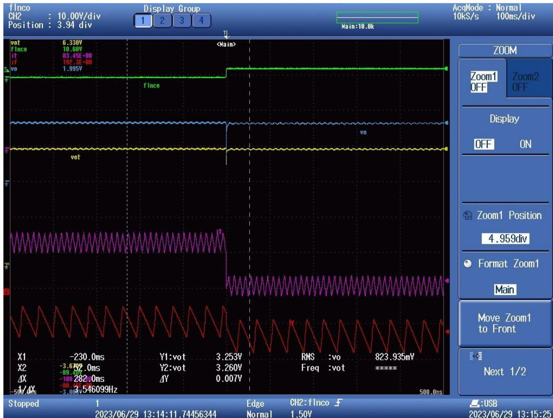
Figura 7-11 Transitorio de cambio de la corriente de carga de 3.3V
