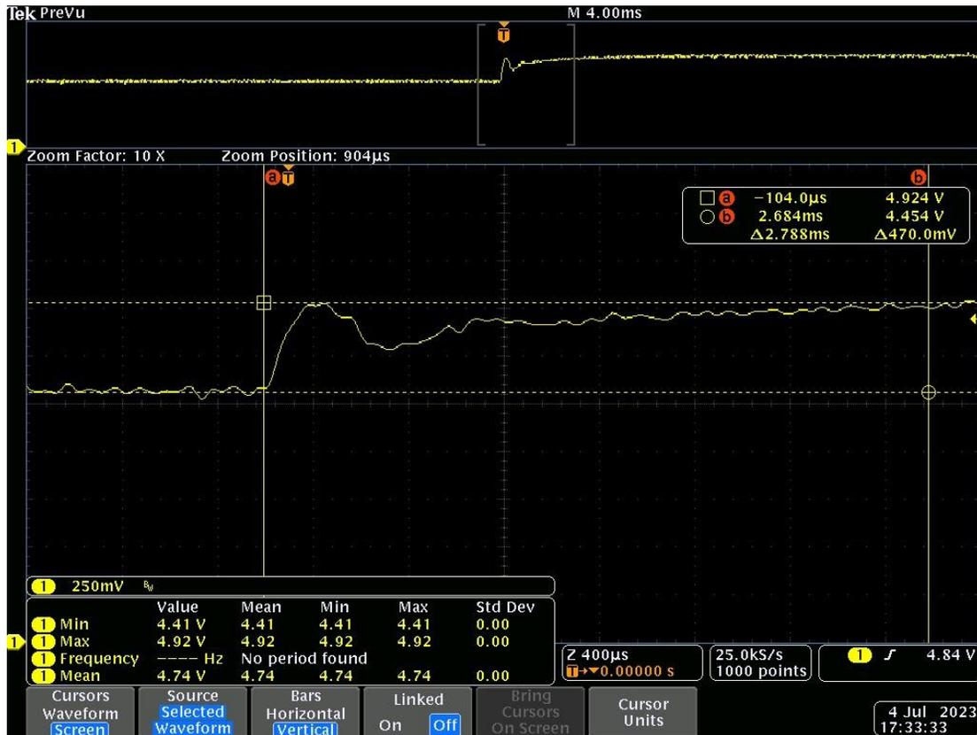
Figura 7-7 Transitorio de cambio de referencia de 5V a 5.5V. Osciloscopio Tektronix. La señal corresponde a la tensión de salida  $V_{out}$ .
