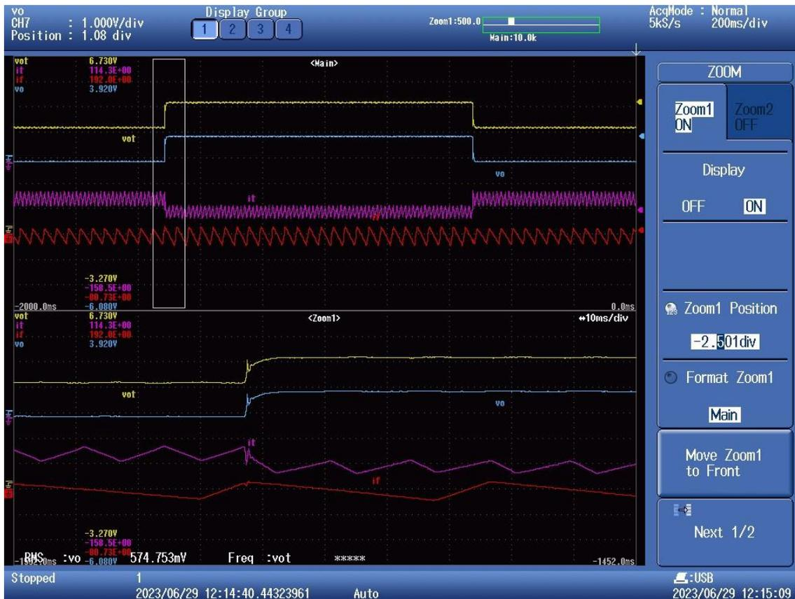
Figura 7-6 Transitorio cambio de referencia entre 2.8 y 3.3V (zoom en la subida de voltaje). Amarillo- Vout. Azul-Vout menos 2.5V. Rojo- Corriente de una de las fases. Morado- Corriente de todas las fases
