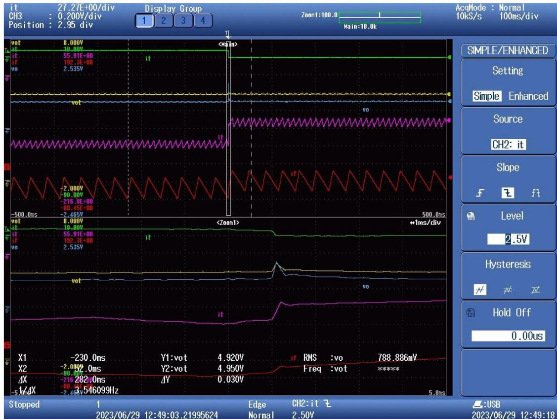
Figura 7-10 Transitorio de cambio de la corriente de carga de 5V. Amarillo- Vout. Azul-Vout menos 4V. Rojo- Corriente de una de las fases. Morado- Corriente de todas las fases. Verde- Señal de flanco
