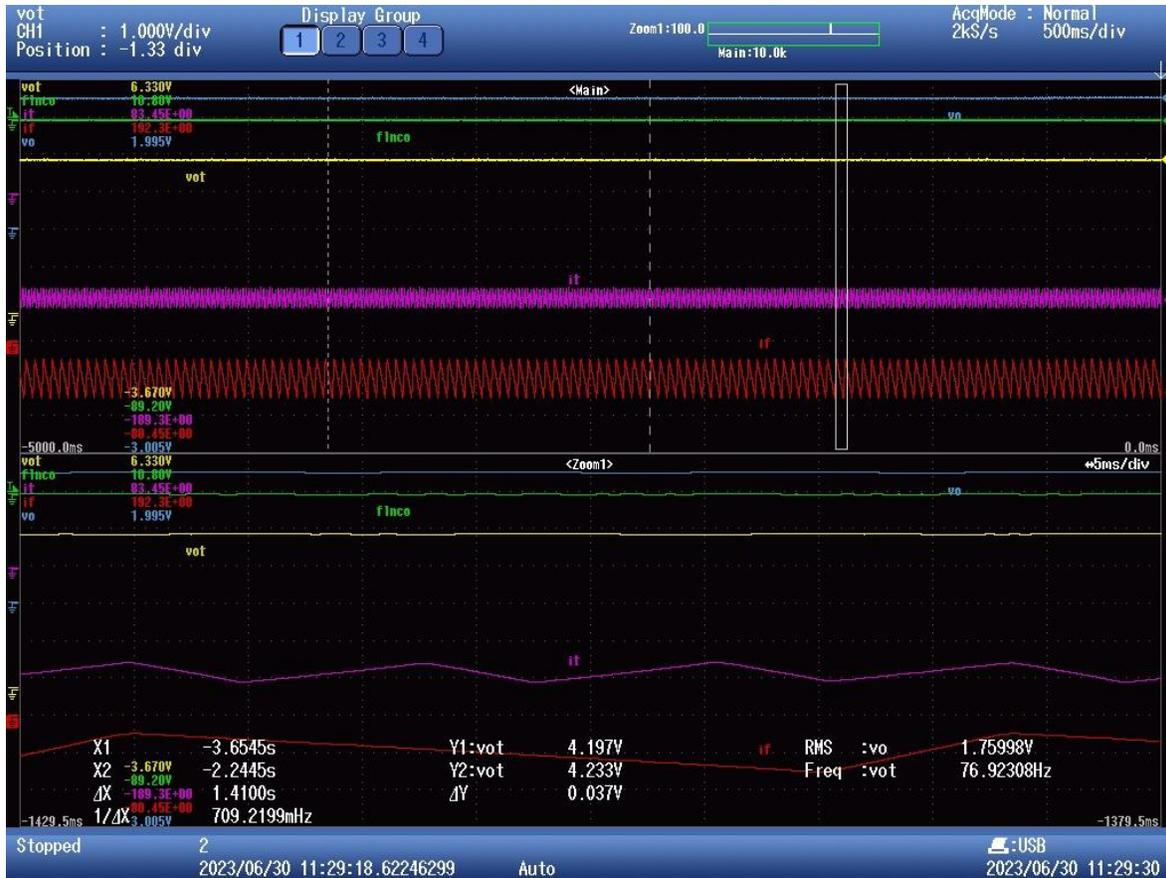
Figura 7-1 Ensayo de lazo abierto en régimen permanente de 5V. Amarillo- Vout. Azul-Vout menos 4V. Rojo- Corriente de una de las fases. Morado- Corriente de todas las fases
