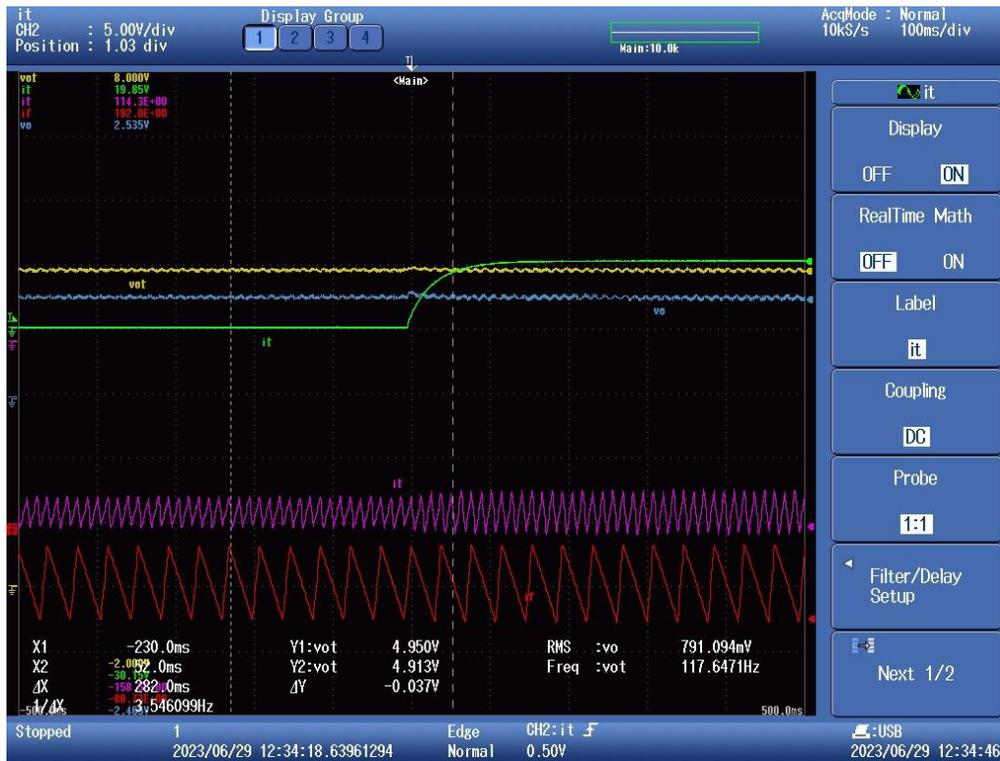
Figura 7-13 Transitorio de subida de la tensión de entrada de 5. Amarillo- Vout. Azul-Vout menos 4V. Rojo- Corriente de una de las fases. Morado- Corriente de todas las fases. Verde- Señal de flanco
