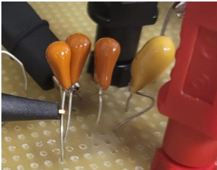
Figura 3-4 Capacitores electrolíticos de  $1\mu\text{F}$  y  $10\mu\text{F}$
