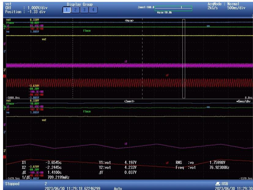
Figura 3. Ejemplo de lectura de osciloscopio. (Amarillo- Vout. Rojo- Corriente de una de las fases. Morado- suma de corriente de todas las fases)
