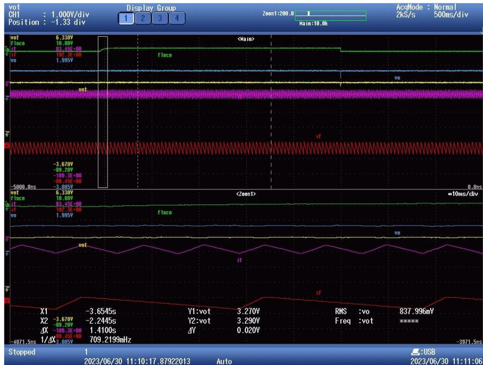
Figura 7-14 Transitorio de subida de la tensión de entrada de 3.3V. Amarillo- Vout. Azul-Vout menos 2.5V. Rojo- Corriente de una de las fases. Morado- Corriente de todas las fases. Verde- Señal de flanco
