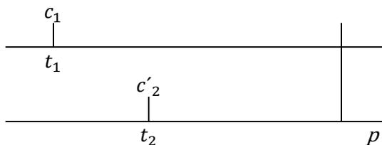
$$c_1 [1 + i(p' - t_1)] = c'_2 [1 + i(p' - t_2)]$$
