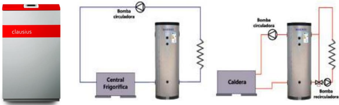
Ilustración 102. Bomba de calor geotérmica Claussius Classic y Depósito de Inercia IDROGAS AR-A100. (Fuente: GeoIntegral)
