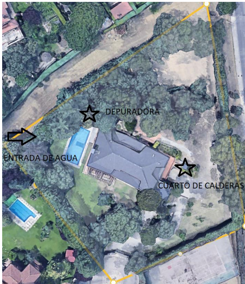
Ilustración 133. Vista en Planta de la casa con los principales puntos del sistema hidráulico. (Fuente: Google Earth)
