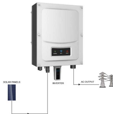
Ilustración 63. Aspecto de un inversor solar. (Fuente: PNI)
