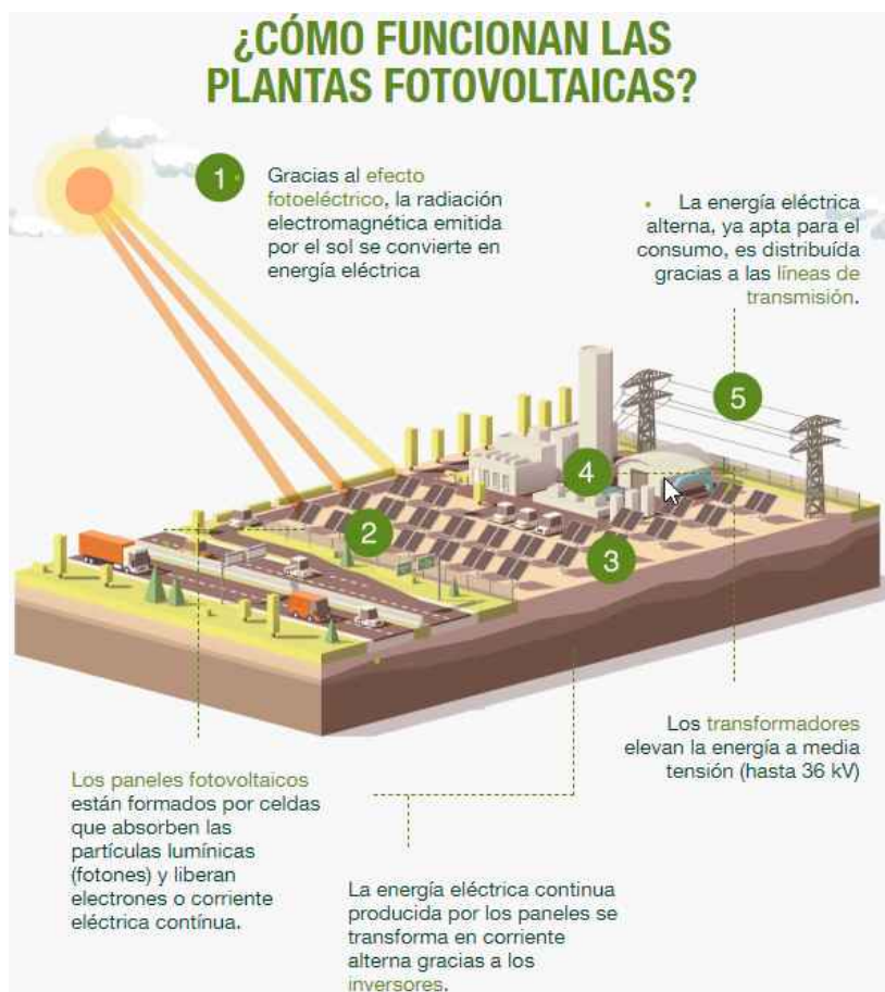
Figura 9: Funcionamiento de una planta fotovoltaica
