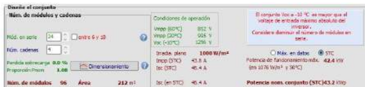
Figura 46: Parámetros de potencia, tensión e intensidad para 4 ramas con 24 módulos por rama
