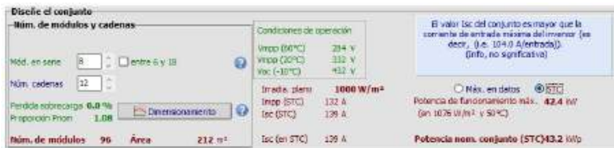
Figura 44: Parámetros de potencia, tensión e intensidad para 12 ramas con 8 módulos por rama
