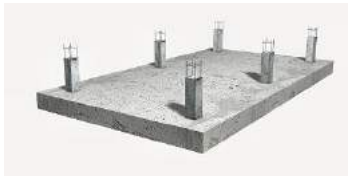
Figura 19: Representación losa de cimentación
