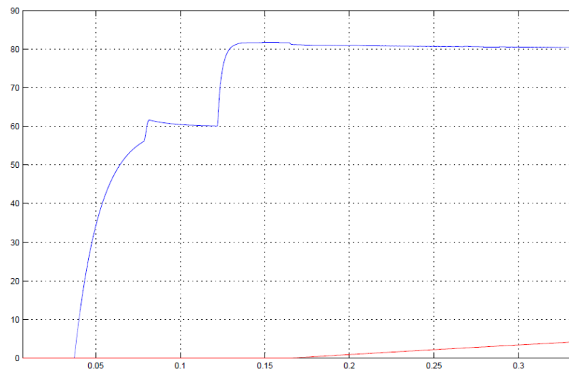
Figura 80: Simulación Arranque (detalle): Tensiones (V)
