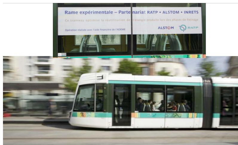
Figura 110: Línea T3 de tranvía de París, en pruebas con un SAE embarcado a base de supercondensadores [5].
