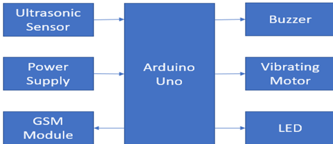
Fig 13. Diagrama de bloques mostrando el entorno de la invención, en el que se puede ver claramente la modularidad del sistema y la capacidad de añadir sistemas de interacción con el usuario (A la derecha del bloque representando al Arduino Uno). (A Smart Wearable Guiding Device for the Visually Impaired People: K P Venkat Vivek, J Vandana, K Sripooja, Abhishek Choubey, 2022)
