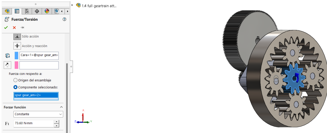
Fig 40. Captura de pantalla enseñando la condición de par de entrada del segundo sistema de engranajes. Elaboración propia usando SolidWorks.
