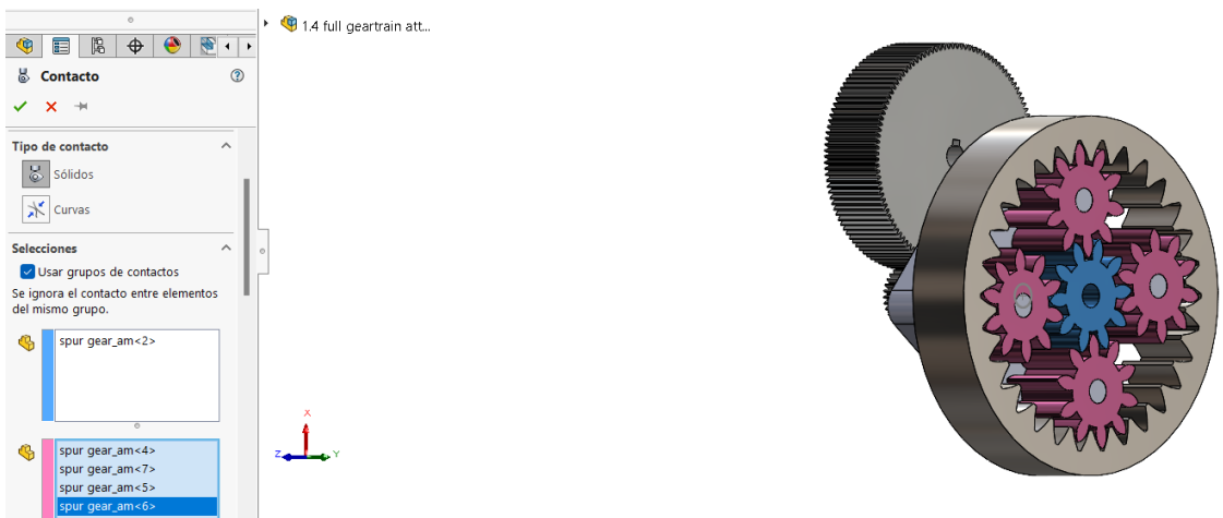
Fig 41. Captura de pantalla enseñando la condición de contacto entre el sol y los planetas del segundo sistema de engranajes. Elaboración propia usando SolidWorks.
