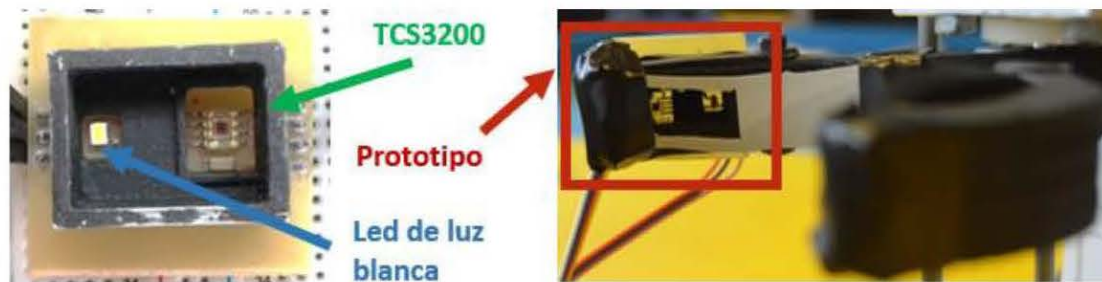
Ilustración 4. A la izquierda, el prototipo del sistema de detección de colores. A la derecha, el mismo prototipo instalado en la pinza.
