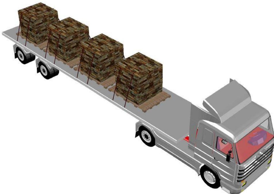
AutoCAD 49. Bloques de piedra pequeños trincados
