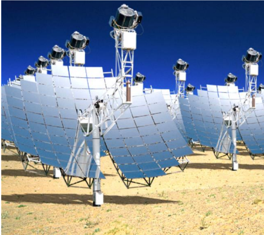
Imagen 1.5: Colector solar de disco parabólico
