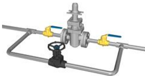
Ilustración 16. Ejemplo de un by-pass de tuberías Fuente: TLV
