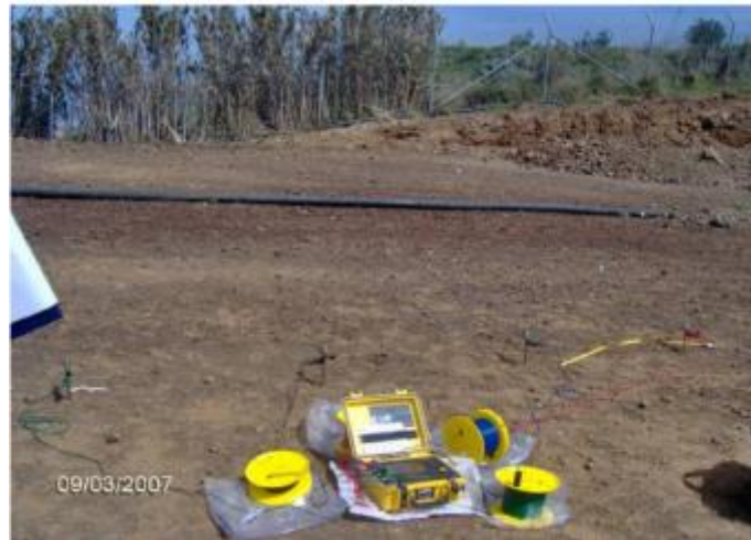
Ilustración 62. Telurímetro y ensayo de resistividad eléctrica.
