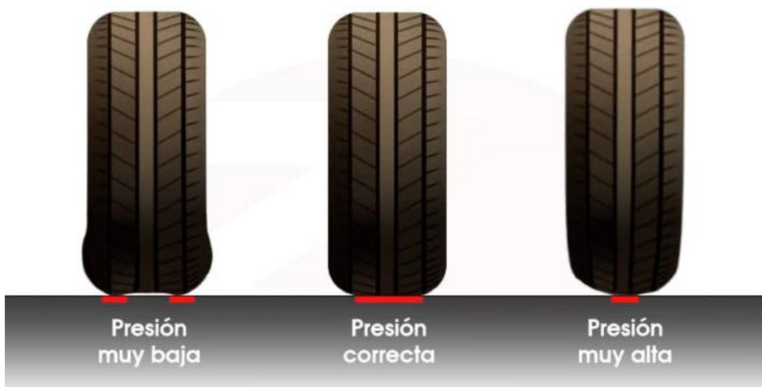
Ilustración 43: Diferencia de áreas según presión de neumáticos 49
