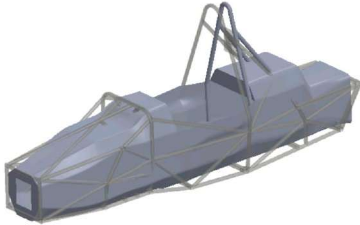
Figura 1. Superposición de un chasis tubular y un monocasco
