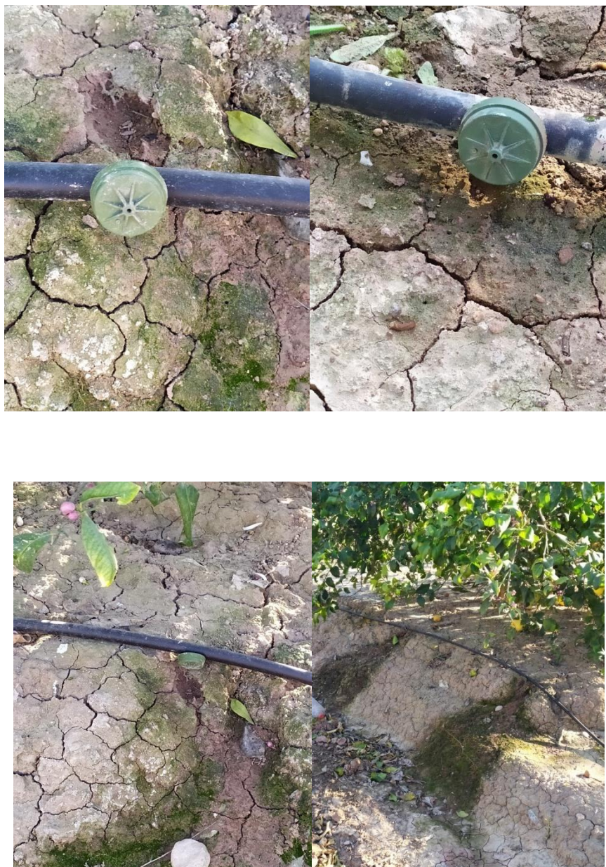
Goteros autocompensantes de 4 l/h
