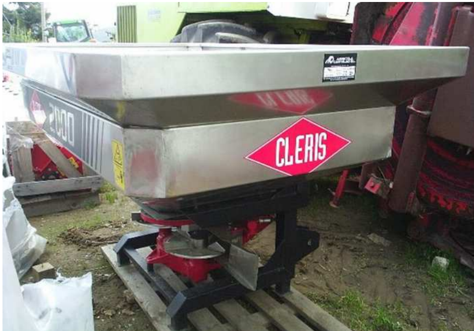
Imagen 4 - Abonadora centrífuga de doble plato de 1.500 kg
