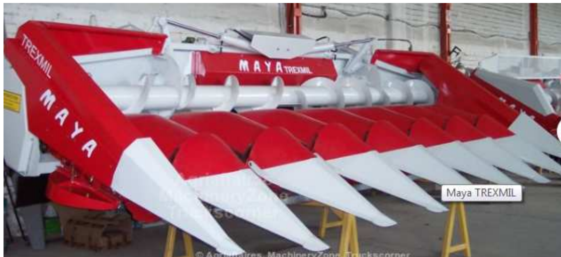
Imagen 14 - Peine para el maíz. La máquina es la misma que para el trigo y el girasol
