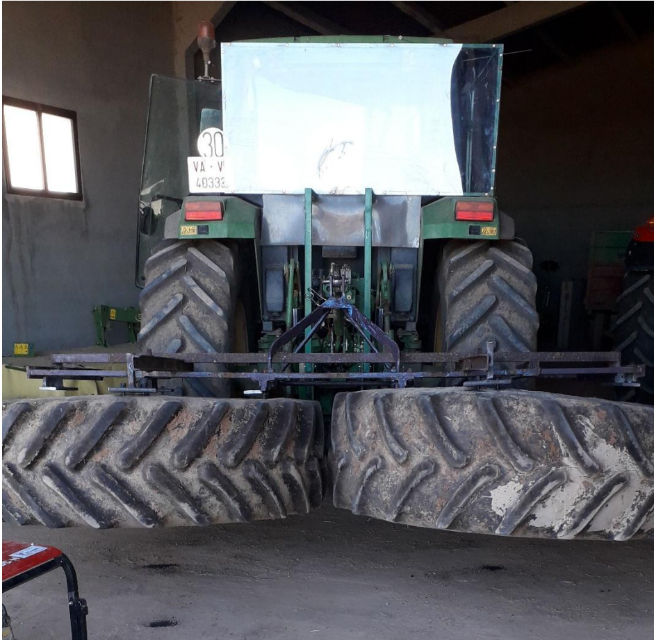
Rastra de ruedas para rotura de tallos de fabricación casera con un viejo cultivador.
