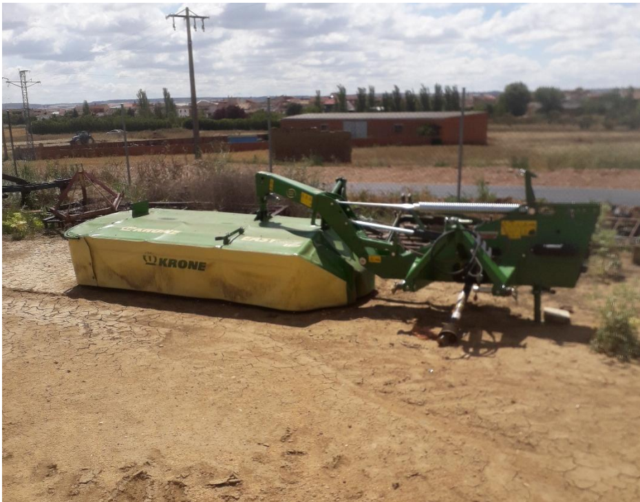
Arriba segadora de forraje suspendida Krone de 2.70 m de corte y abajo rastrillo de forraje de 3.40 m de tajo.
