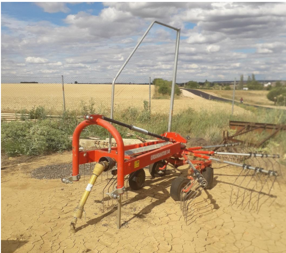
Arriba segadora de forraje suspendida Krone de 2.70 m de corte y abajo rastrillo de forraje de 3.40 m de tajo.
