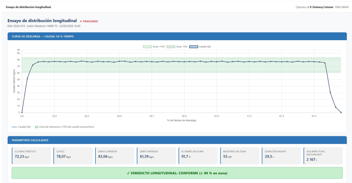
Figura 24. Módulo de ejecución del ensayo de distribución longitudinal
