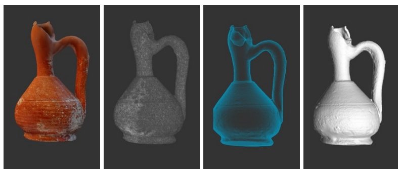
FIGURA 1. Empleo del programa Autodesk Recap Photo para la creación de representaciones virtuales de las piezas de la colección arqueológica. En la imagen se presentan las visualizaciones del modelado tridimensional en modo textured, wireframe, xray y solid.
