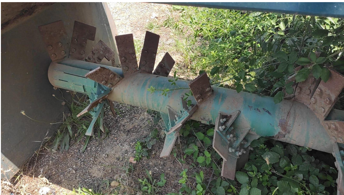
Ilustración 46: Detalle de las palas de la volteadora
