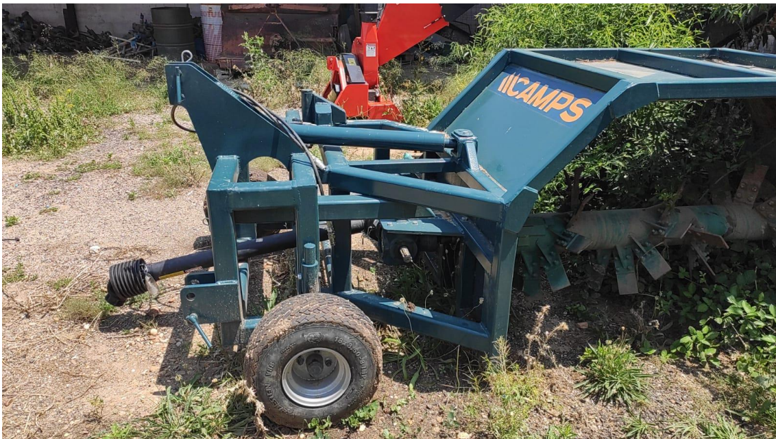
Ilustración 48: Detalle del enganche de la volteadora
