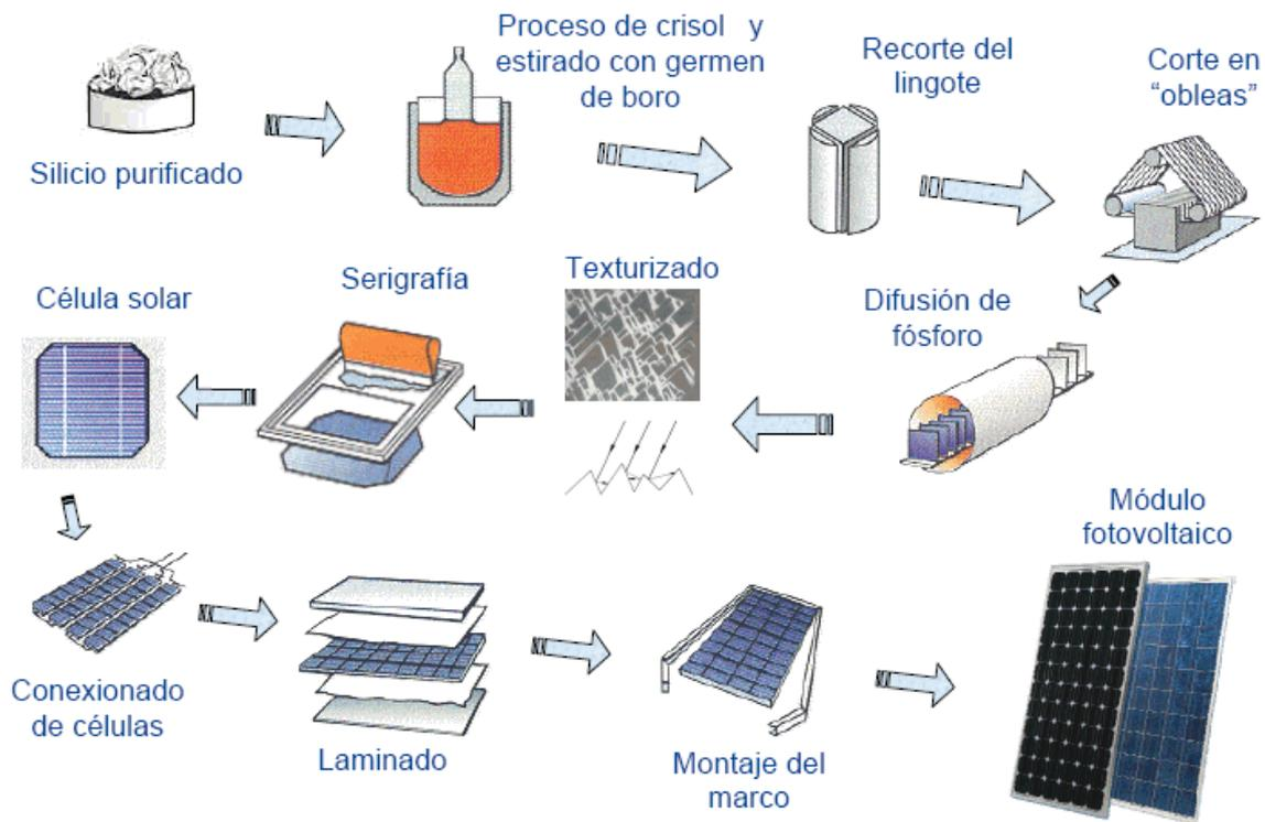
Figura 16: Proceso de fabricación de células y paneles fotovoltaicos. Fuente: [www.electricidad-gratuita.com](http://www.electricidad-gratuita.com).
