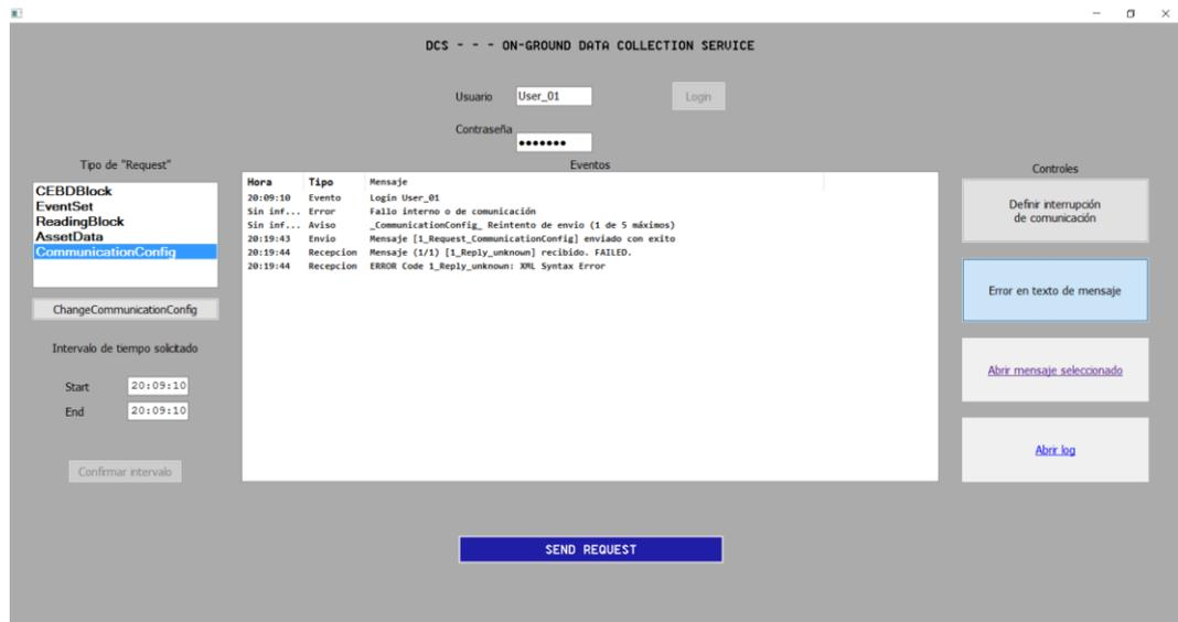
Figura 14: Ventana del DCS: alteración de mensajes y funcionalidad ante mensajes corruptos
