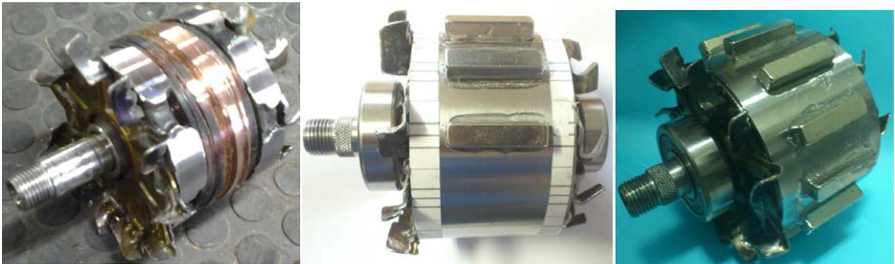
Figura 31: torneado del rotor, pegado de imanes y aspecto final
