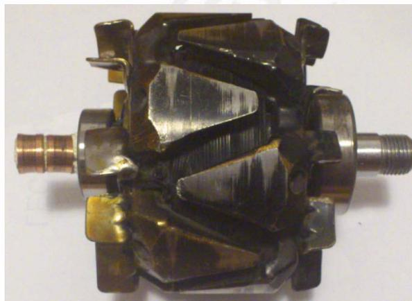
Figura 3: rotor bobinado (inductor)
