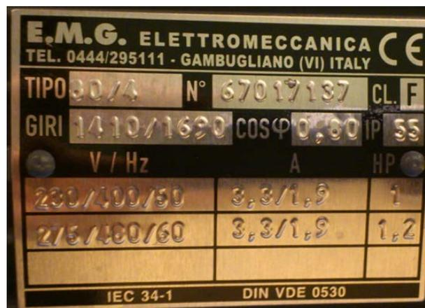
Figura 10: placa de características del motor
