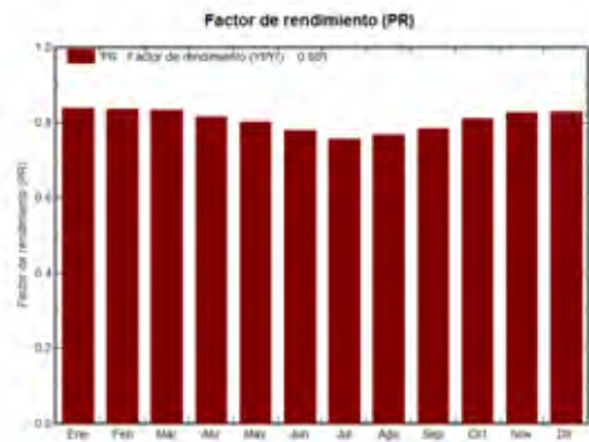
Figura 35- Factor de rendimiento Cubierta (Fuente PVSyst)
