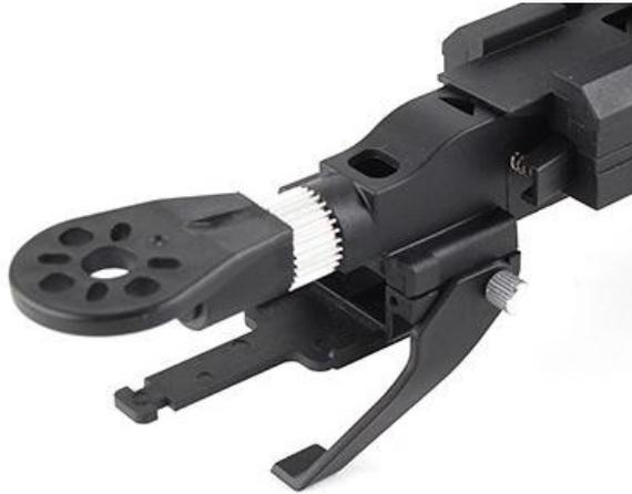
Figura 2.2 Adaptación del Servo
