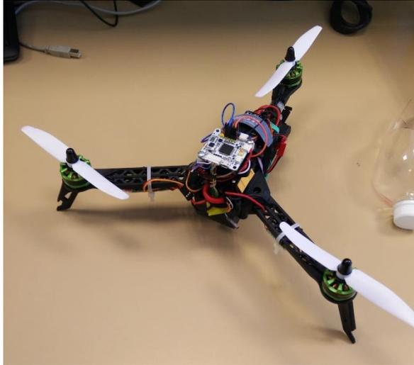
*Figura 7.2 Tricóptero con las hélices bipala*
