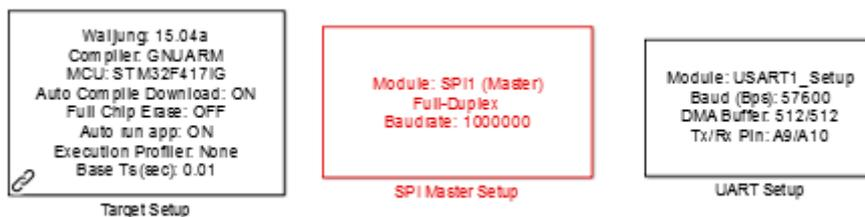
Figura 5.1 Bloques de Configuración del Microcontrolador, del módulo SPI y UART
