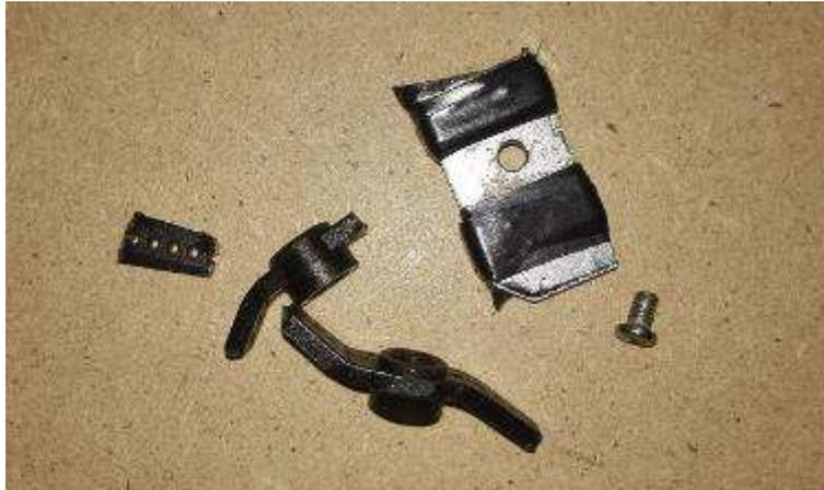
Figura 87: Brazos de servomotor inservibles
