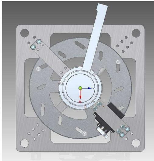
*Diseño del péndulo invertido con volante de inercia y sistema de frenado*
