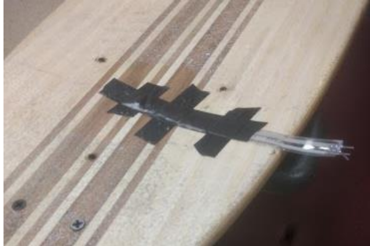
Ilustración 10: Vista del sensor delantero una vez unido a la tabla. También se pueden apreciar el lijado y los agujeros mencionados en el paso anterior.
