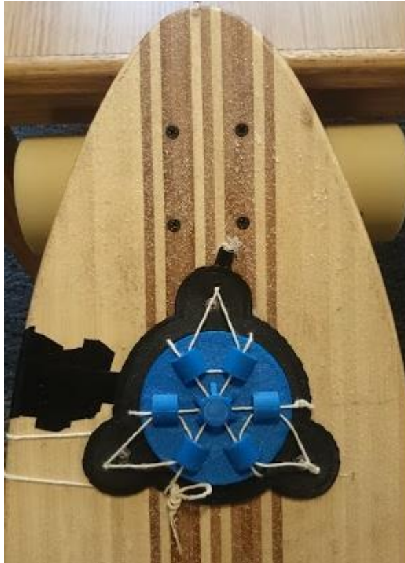
Ilustración 11: Vista superior de la cubierta del sensor delantero una vez instalada.
