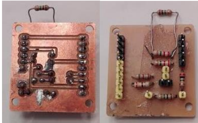
Ilustración 8: Vista superior e inferior de la placa de circuito impreso empleada, con los elementos electrónicos y pines debidamente soldados.
