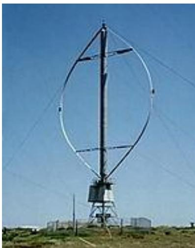
FIGURA 3: TURBINA EÓLICA DE EJE VERTICAL
