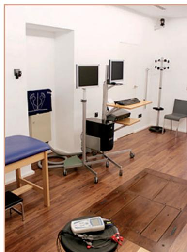
Para transformar dicha fuerza en una señal electrónica se utilizan dos tecnologías de transductores: extensométricos y piezoeléctricos. Dichos transductores pueden ser bidimensionales o tridimensionales, según registren fuerzas en dos o tres direcciones perpendiculares.
