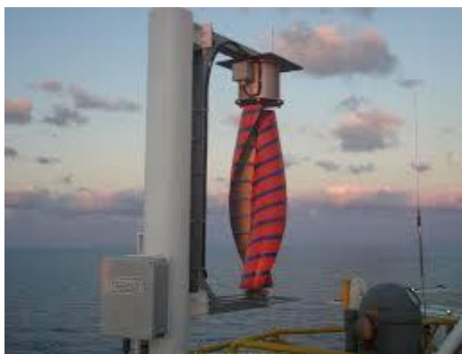
Figura 2. Generador vertical tipo Savonius. (9)
