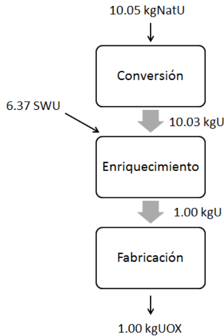
Figura 41 – Flujo de masas para la obtención de 1 kg de combustible UOX a partir de uranio natural. Fuente: [12]
