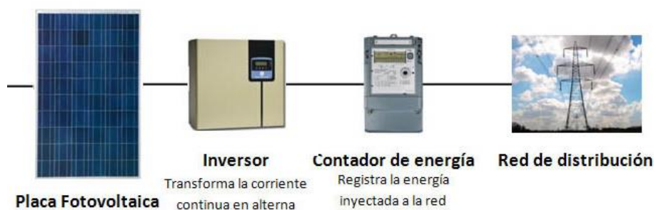
Figura 26. Sistema conectado a la red eléctrica.
