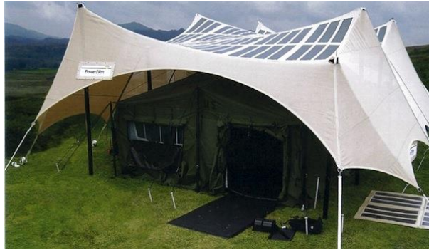
Figura 3. Tecnología flexible fotovoltaica en una tienda de campaña.
