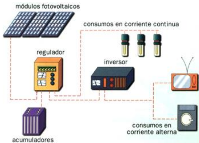
Figura 33. Instalación en tensión continua y alterna.
