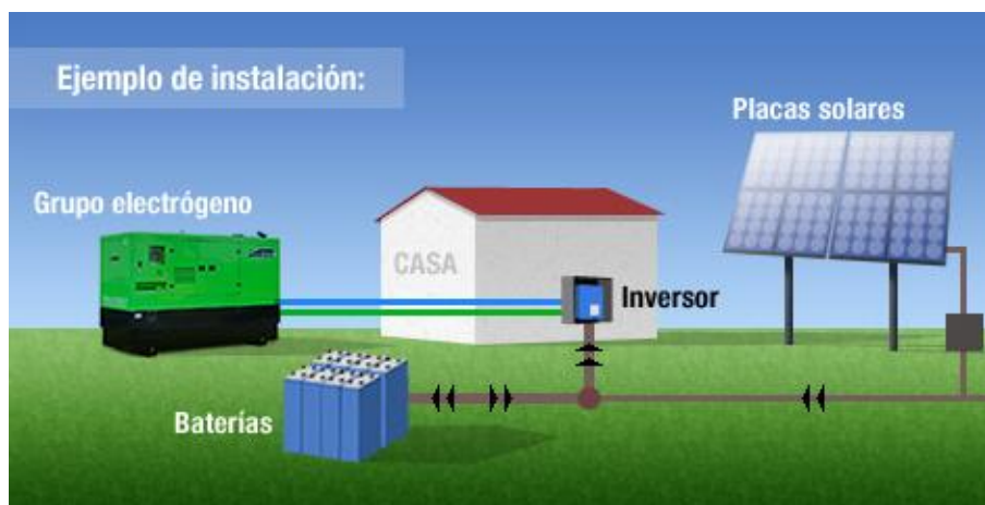
Figura 25. Sistema solar fotovoltaico-diésel aislado de la red eléctrica.
