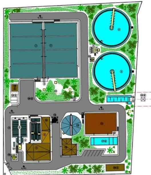
Se proyecta un pretratamiento totalmente nuevo formado por un bombeo de agua bruta, desbaste de materiales finos (inf. 3 mm) con tamices automáticos y desarenado-desengrase en dos unidades rectangulares.
