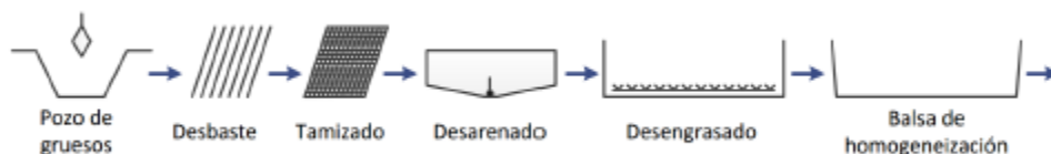
Figura 9: Esquema general de la fase de pretratamiento de una EDAR. Fuente [CLED17]
