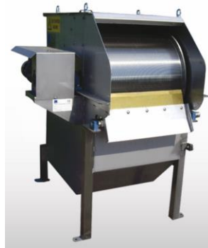
Figura 26: Tamiz rotativo de alimentación externa. Fuente [SAVE18].
