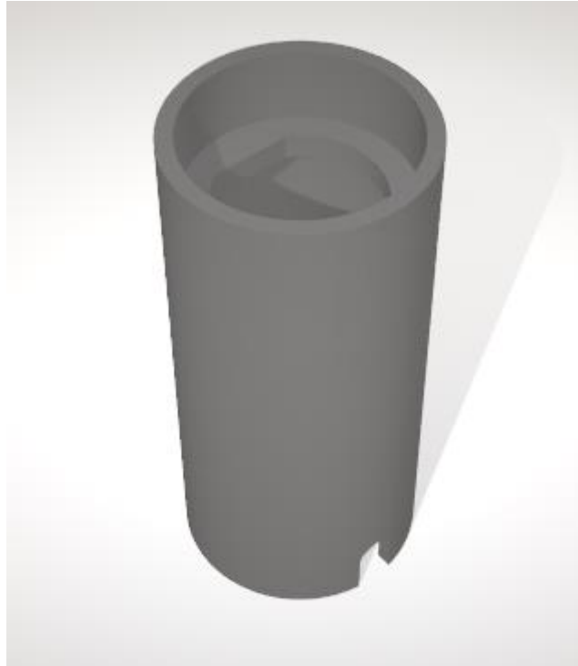
Ilustración 15: Pieza 3D: Soporte del actuador magnético
