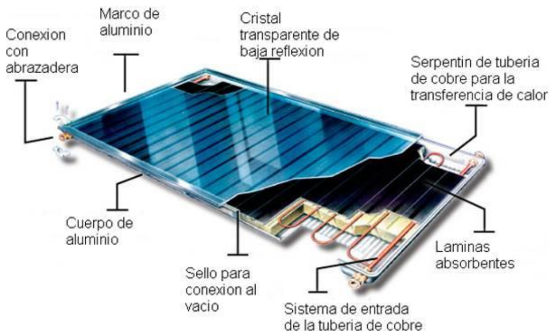
Ilustración 19.- Partes que componen un captador solar térmico
