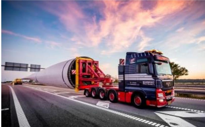
Figura 14: Transporte de la pala de un aerogenerador. Fuente<sup>xii</sup>
