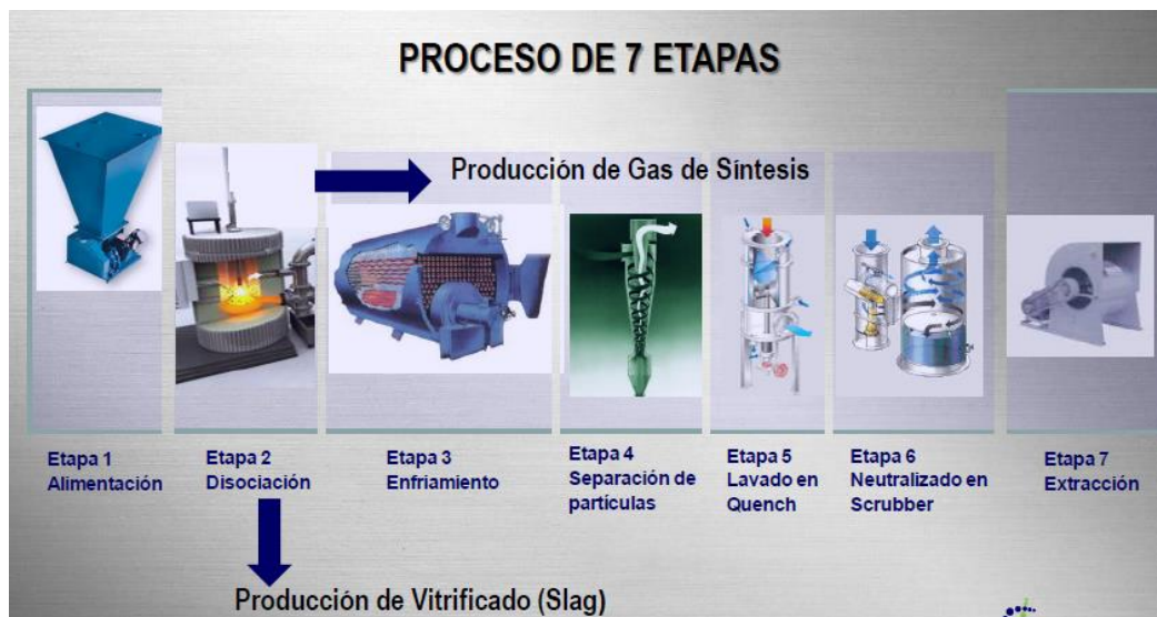
Figura 34. Proceso de las 7 etapas en la gasificación por plasma de residuos.
