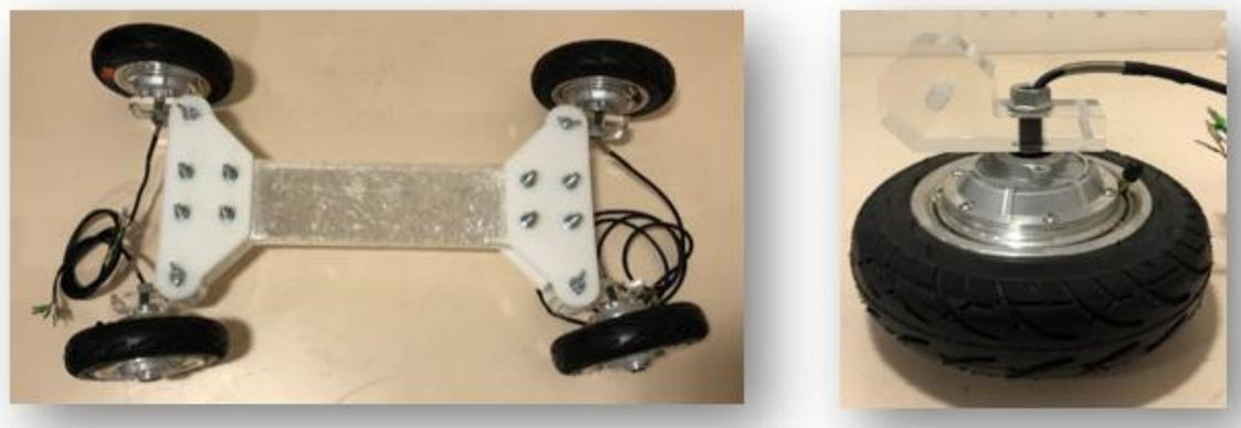
Figura 62: Bastidor y soporte de las ruedas.
