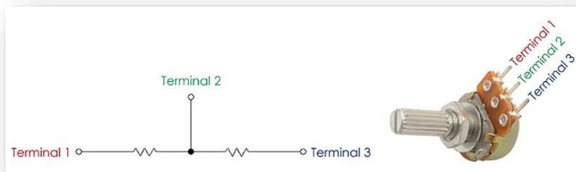
Figura 25: Diagrama de un potenciómetro.
