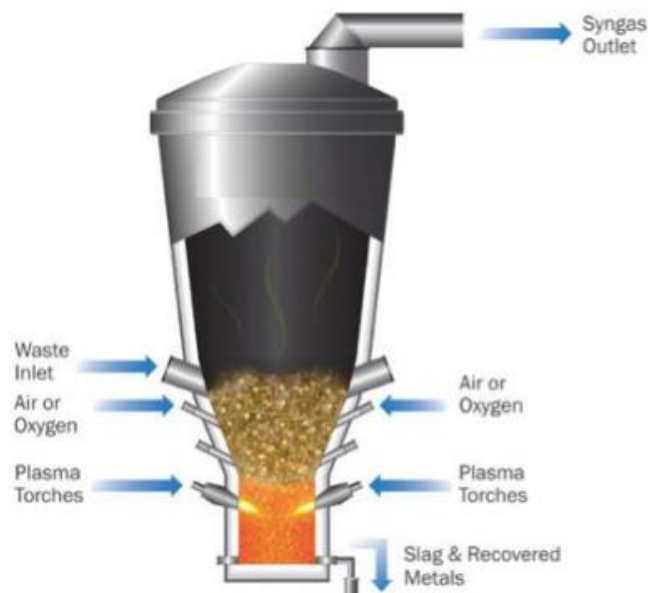
Figura 25. Cámara de gasificación por plasma
