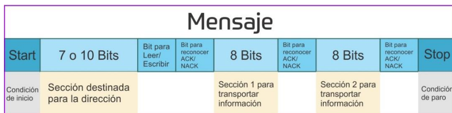
Figura 26. Estructura de un mensaje I2C
