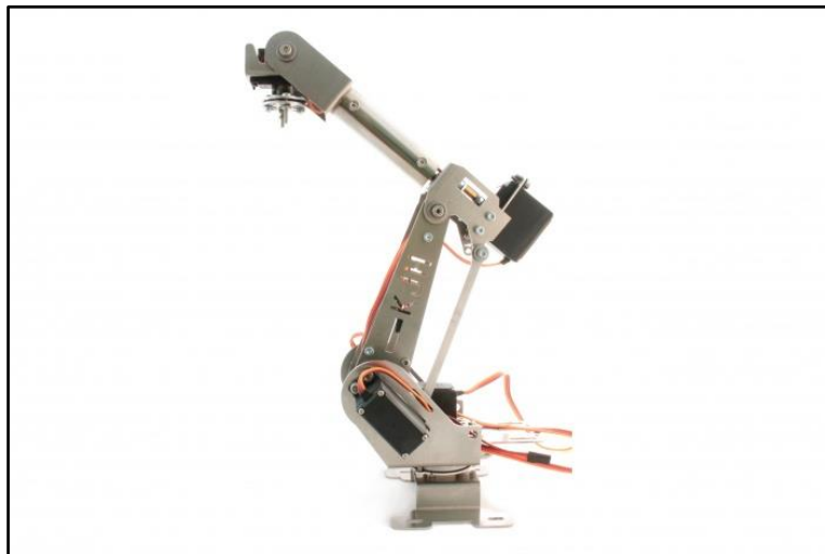
Figura 2. Brazo robótico de seis grados de libertad.
