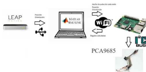
Figura 23. Diagrama de conexiones y comunicaciones.
