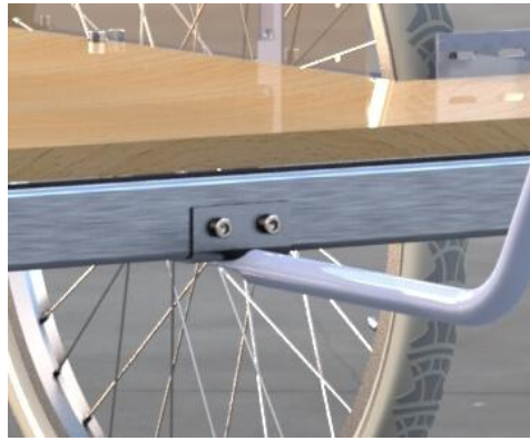
Figura 2.22. Pieza de conexión entre la barra y el bastidor - Creado con SOLIDWORKS VISUALIZE por Álvaro Otero.
