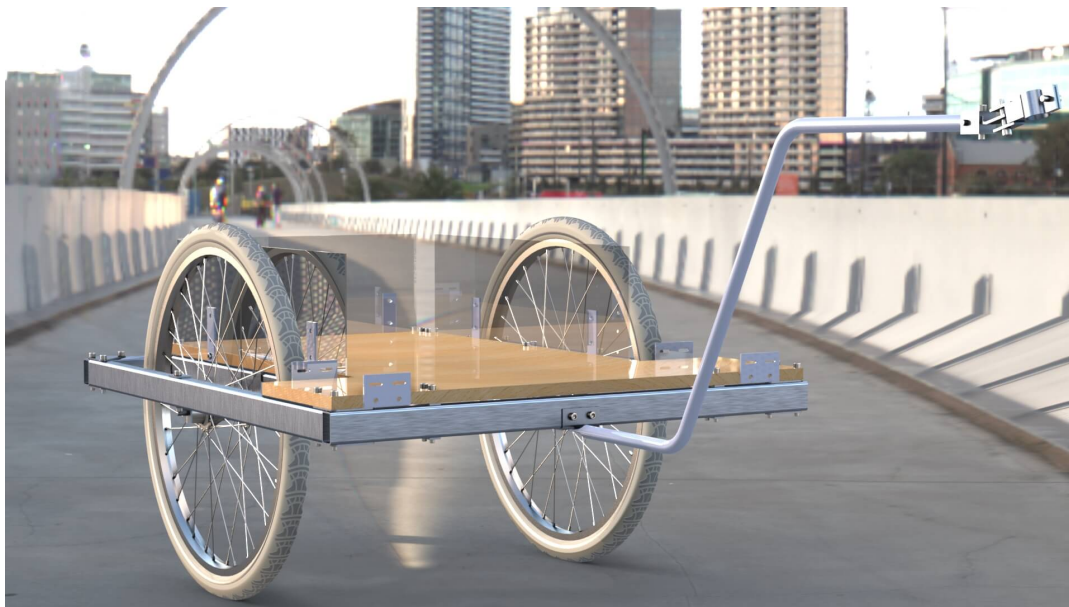
Figura 2.24. Imagen (2) renderizada del diseño definitivo del conjunto - Creado con SOLIDWORKS VISUALIZE por Álvaro Otero.
