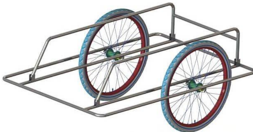
Figura 2.5. Modelo CAD del bastidor de tubos de hierro - Creado con SOLIDWORKS VISUALIZE por Álvaro Otero.
