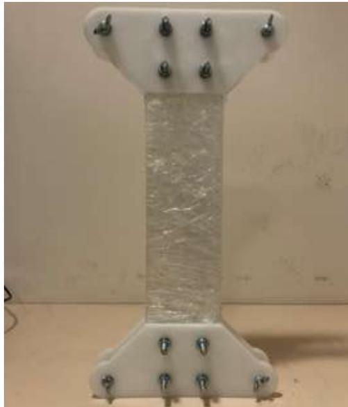
Figura 55: Bastidor flexible formado por el bastidor de metacrilato y las ballestas de polietileno
