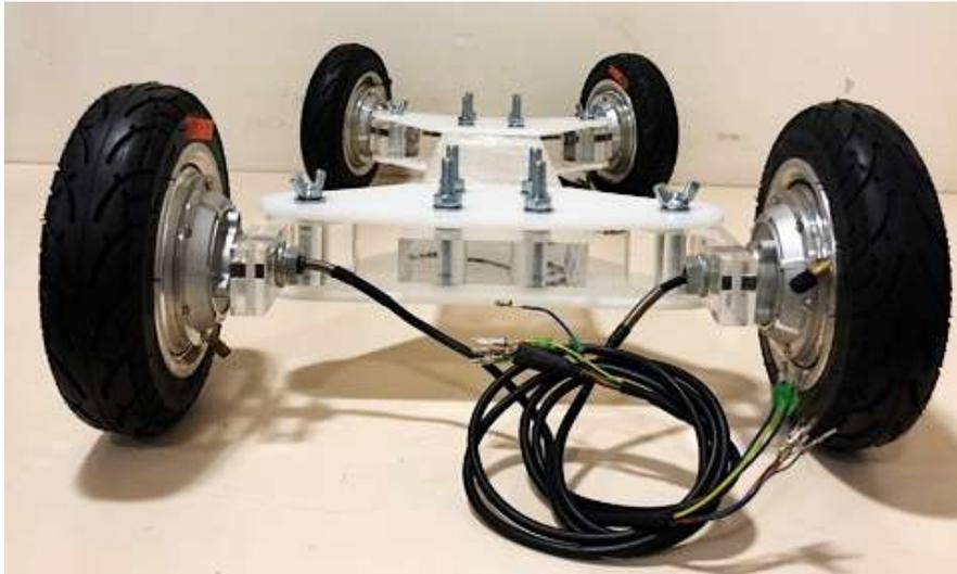
Figura 58: Imagen frontal del bastidor con los cuatro motores ensamblados
