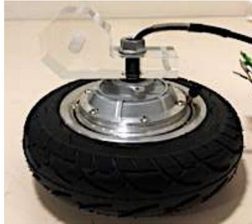
*Figura 57: Sujeción entre los motores y las ballestas del bastidor*
