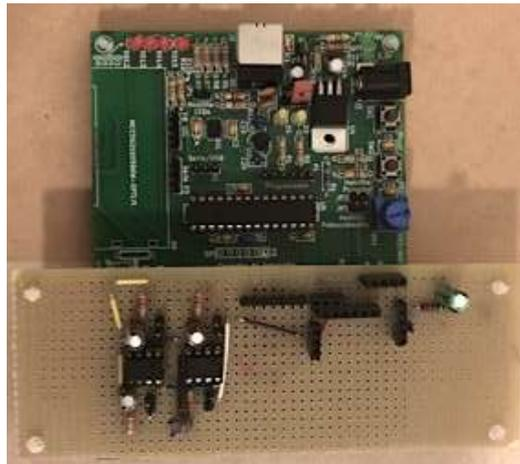
Figura 54: Microcontrolador con tarjeta PicTrainer y placa con las señales de entrada y salida y componentes de acondicionamiento
