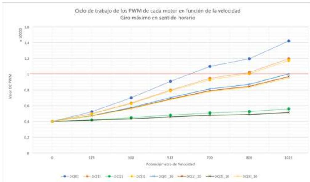
Figura 34: Rango de los ciclos de trabajo de las señales PWM en función de la velocidad de avance y para un giro de 45° en sentido horario
