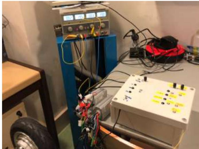
Figura 62: Conexión de los motores con sus respectivos controladores, con el mando de control y con la fuente de alimentación
