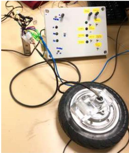
Figura 60: Montaje panel de control, controlador y motor para pruebas de funcionamiento sobre un motor
