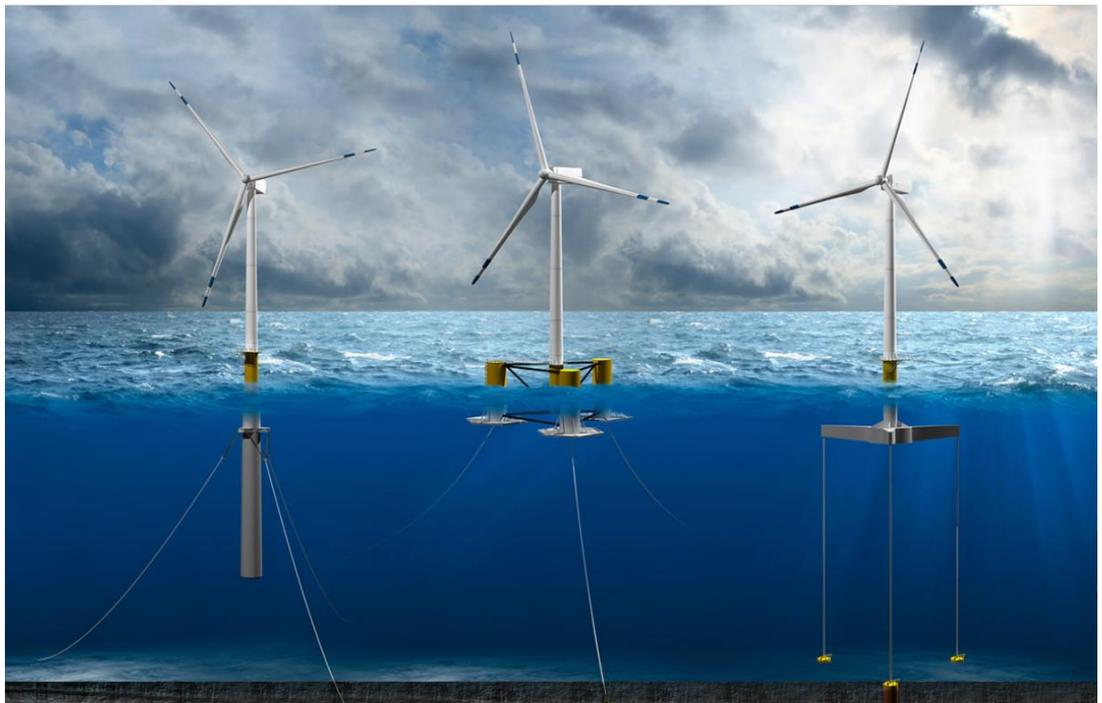
*Imagen 4: Principales topologías de aerogeneradores marítimos flotantes. Desde la izquierda: mástil, plataforma semisumergida y TLP. Fuente: DNV GL*
