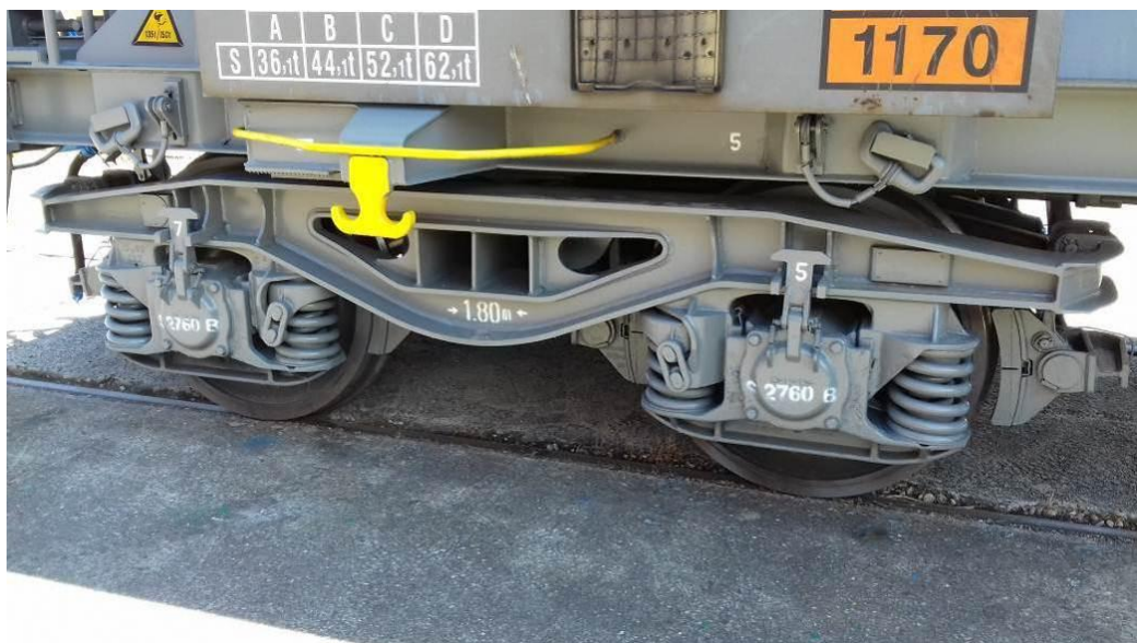
Figura 5.9. Bogie tipo Y21 recién reparado, pintado y montado en el vagón.
