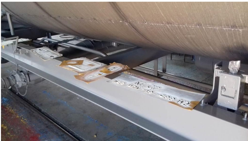
Figura 5.18. Proceso de rotulado y estampillado de las inscripciones del vagón.
