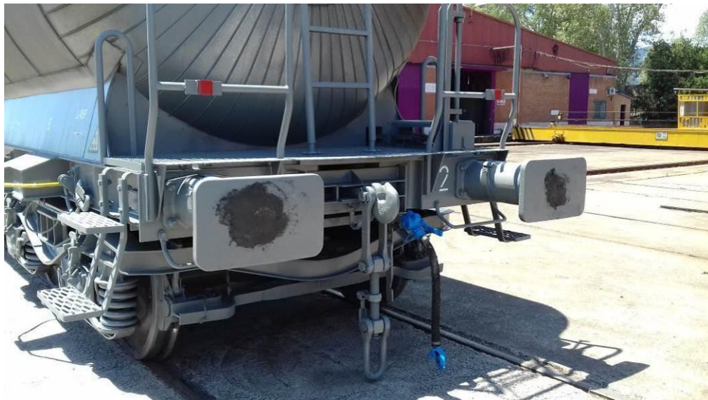
Figura 5.15. Grasa lítica aplicada en los platos de los topes del vagón.
