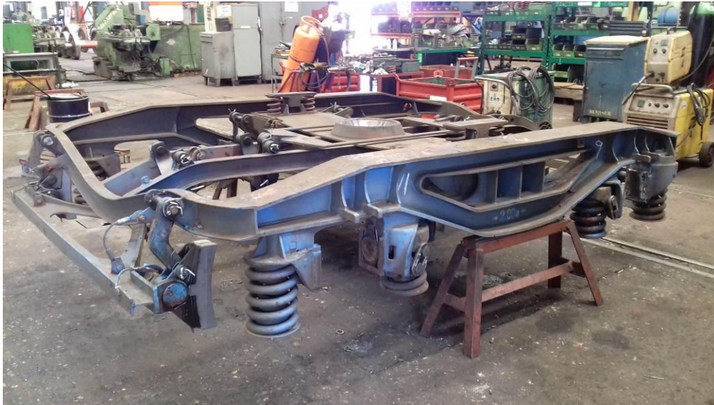
Figura 5.12. Bastidor de bogie en proceso de reparación en su sección.
