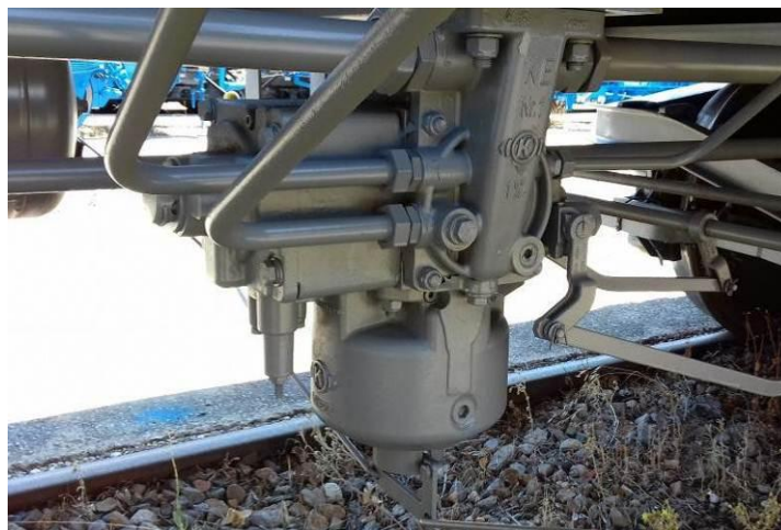
Figura 5.11. Distribuidor de freno KE ya instalado en el vagón.
