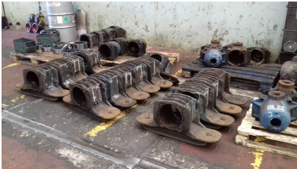
Figura 5.17. Cajas de grasa en sección para su reparación.
