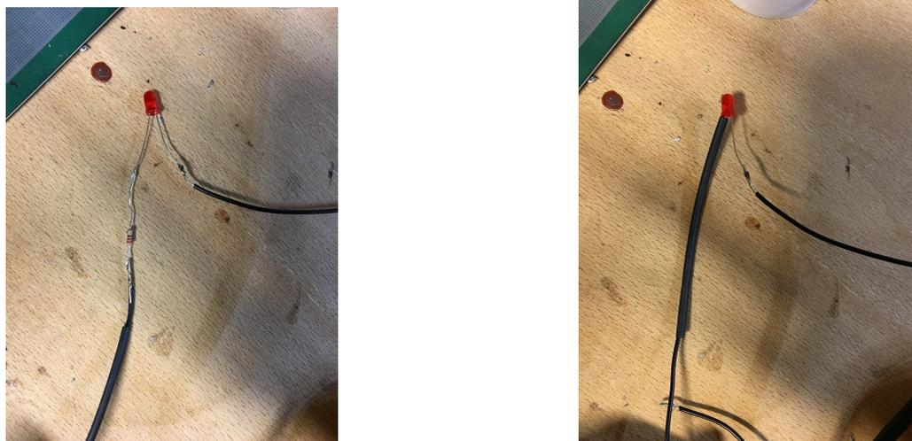
Figura 39: Conexión de LEDs y aislamiento
