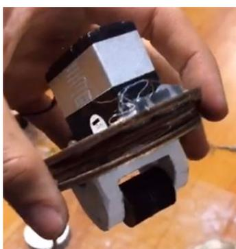
Figura 37: Soporte Servo impreso en 3D
