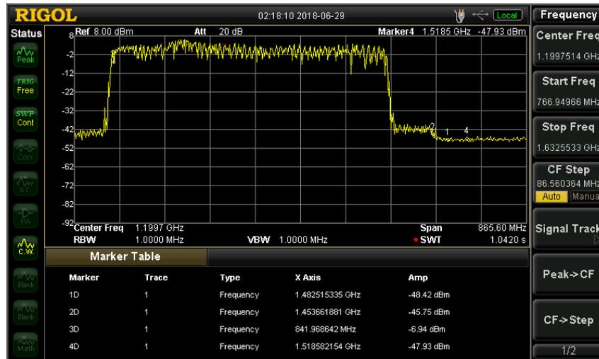
Ilustración 57 – Analizador de espectros de la salida del sensor, siendo el aire el dieléctrico utilizado.
