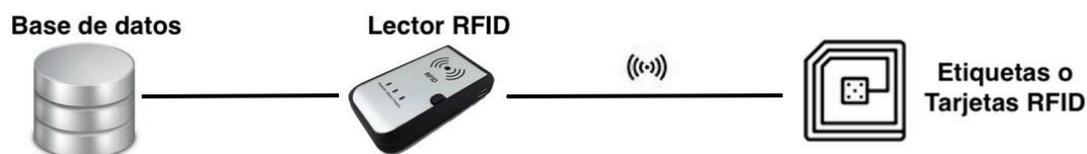
*Ilustración 10 – Esquema funcionamiento RFID*
